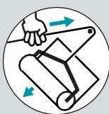
TAGPAPPEN FIRES NED MED EN HÅND UNDER BRÆNDING
